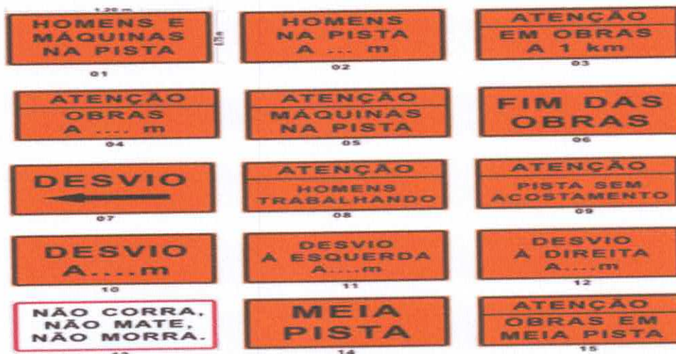
Imagem 07: Representação da Placas de Sinalização de Obras em Rodovia.
