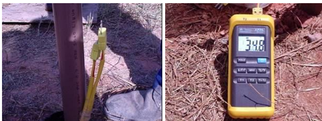
Figura 10:4: Ilustração dos fios dos termopares e do medidor de temperatura digital.
