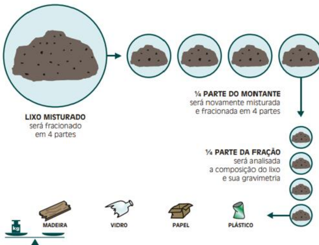
Figura 10.2: Processo de Quarteamento dos Resíduos Sólidos
