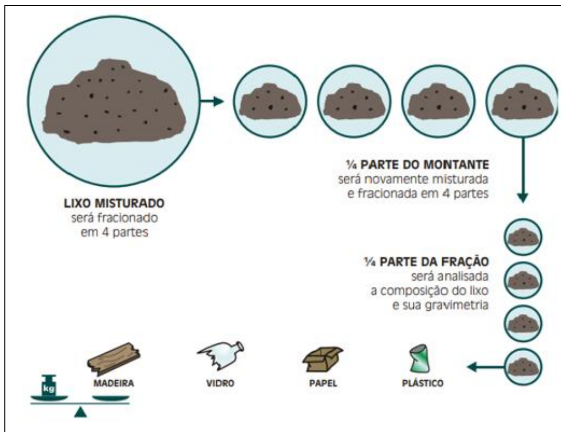
Figura 10.2: Processo de Quarteamento dos Resíduos Sólidos
