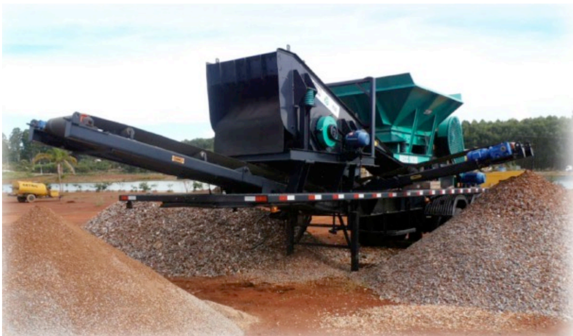
Figura 10 – Imagem da operação do tratamento dos resíduos da construção e demolição. Fonte: Sinertec.
