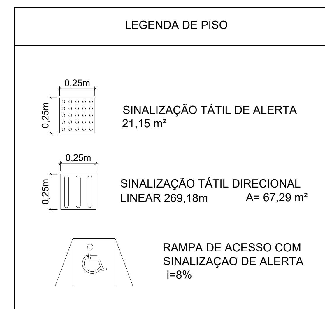
DETALHE DE RAMPA DE ACESSIBILIDADE ESCALA 1/20
