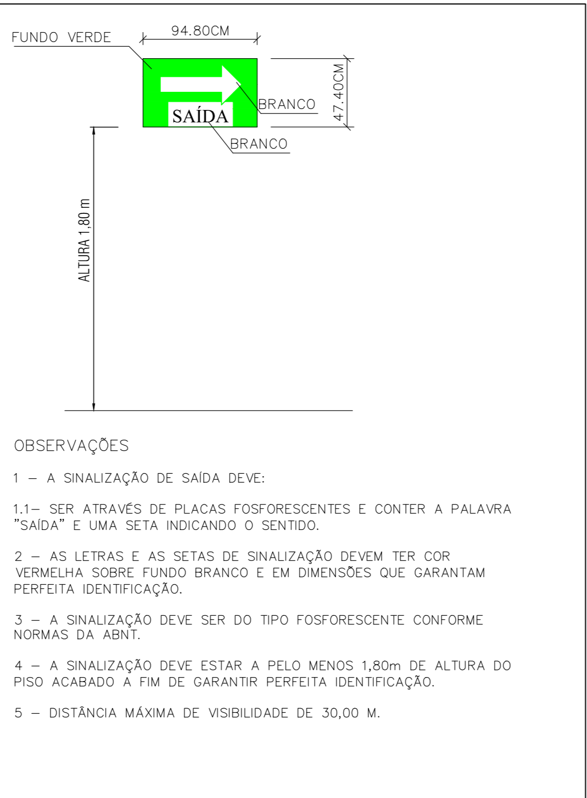
DETALHE 03 - SINALIZAÇÃO DE SAÍDA SEM ESCALA
