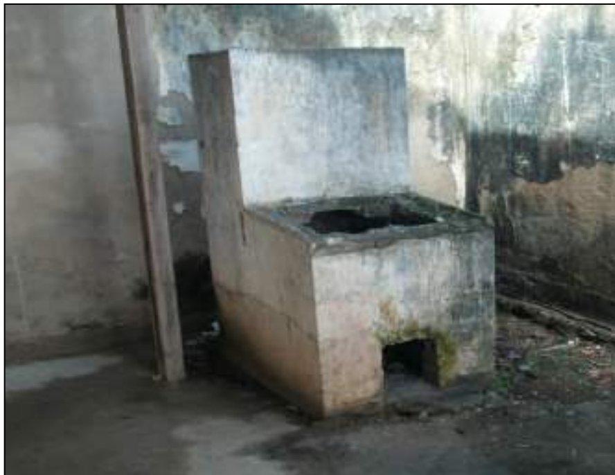
Figura 66: Forno para queima de RSS na unidade de saúde. Amparo de São Francisco. Crédito da foto: Trabalho de Campo. SERGIPE/2010.
