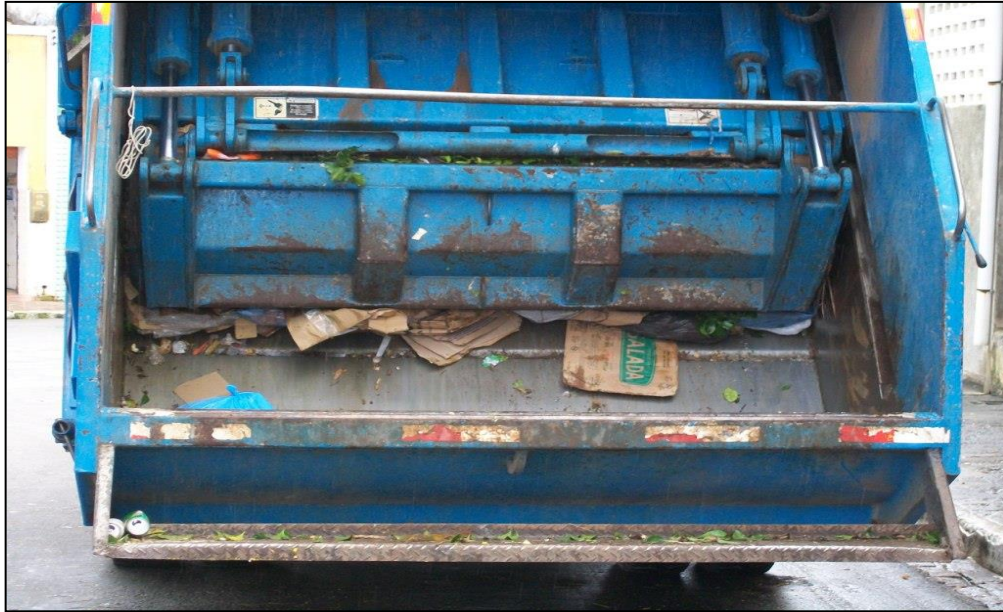
Figura 40: Caminhão compactador – Japaratuba/SE.
