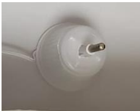
Figura 3: Termômetro – posicionamento no fundo da caixa
