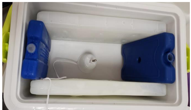
Figura 2: Montagem da caixa térmica – posicionamento das bobinas reutilizáveis (gelox) na parede da caixa térmica e posicionamento do termômetro.
