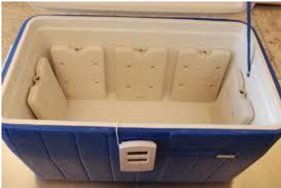
Figura 2: Montagem da caixa térmica – posicionamento das bobinas reutilizáveis (gelox) na parede da caixa térmica e posicionamento do termômetro.
